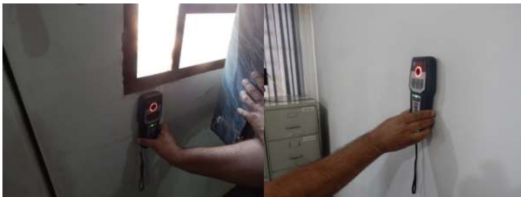
Figura 38: Ensaio não destrutivo de Pacometria
