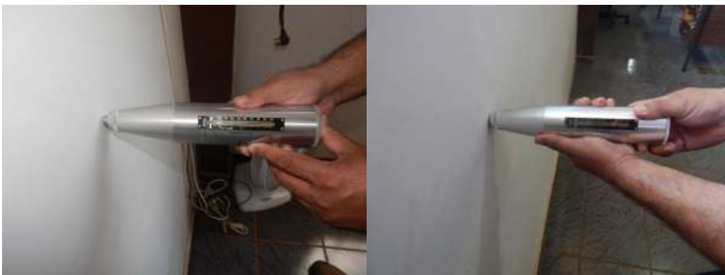
Figura 49: Ensaio não Destrutivo de Esclerometria de Reflexão
