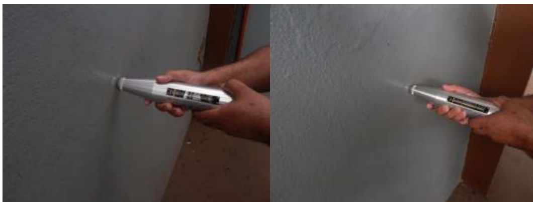
Figura 51: Ensaio não Destrutível de Esclerometria de Reflexão
