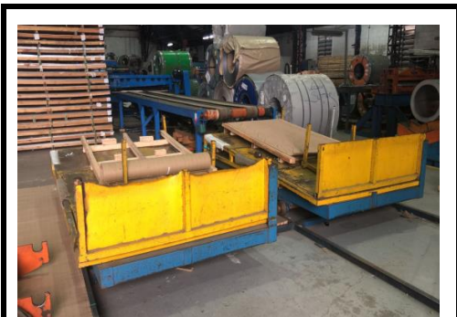
Vista da Mesa de Empilhamento
